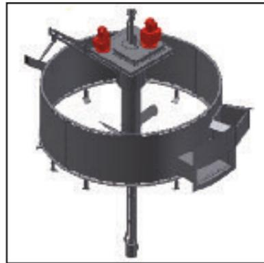
Das FSM-Paddelwerk dient zur Erzeugung einer konstanten Randgeschwindigkeit, die sich auch bei wechselnden Zulaufmengen nicht ändern darf. Es bietet eine hohe Leistung bei geringen Betriebskosten.
